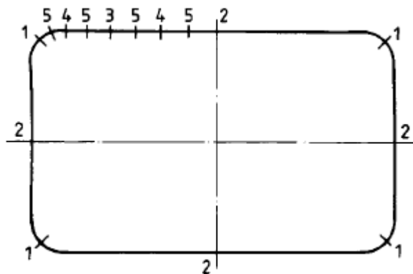
Obr. 6: Schéma sešroubování kulatých kompenzátorů
